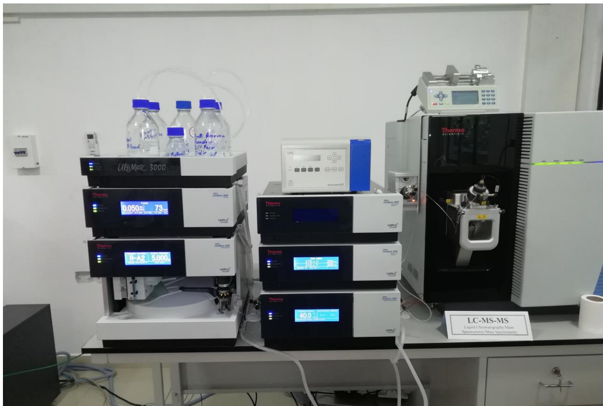
රූපය -3: පළිබෝධනාශක (ජලයේ ද්‍රාව්‍ය සහ ධ්‍රැවීය කාබනික සංයෝග) අවශිෂ්ට ඉතා සියුම් සංවේදීතාවයකින් යුතුව විශ්ලේපණය කර හඳුනාගත හැකි සහ ප්‍රමාණනය කළ හැකි ද්‍රව වර්ණාලේඛ උපකරණය (Liquid Chromatography-Tandem Mass Spectrometry, LC-MS/MS).
