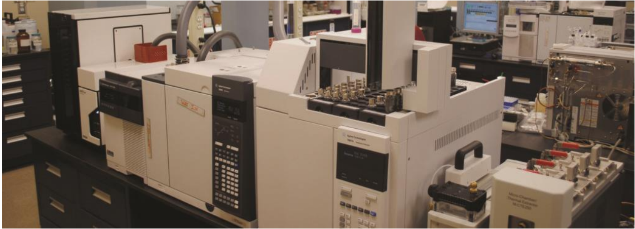
රූපය -5: පලිබෝධනාශක (ජලයේ අද්‍රාව්‍ය, ධ්‍රැවීය නො වන සහ වාෂ්පශීලී කාබනික සංයෝග) අවශිෂ්ට ඉතා සියුම් සංවේදීතාවයකින් යුතුව විශ්ලේෂණය කර හඳුනාගත හැකි සහ ප්‍රමාණනය කළ හැකි වායු වර්ණාලේඛ උපකරණය (Gas Chromatography-Tandem Mass Spectrometry, GC-MS).
