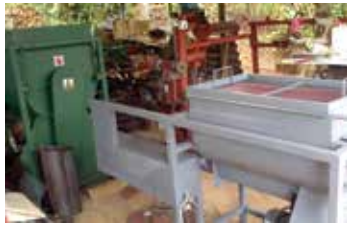
බිම්මල් වගාවේදී ස්වයංක්‍රීයව වගා වාඩ්පය කවලම් කරන හා එළි පිරවීමේ උපකරණය
