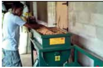
බිම්මල් වගාවේදී ස්වයංක්‍රීයව වගා වාඩ්පය කවලම් කරන හා එළි පිරවීමේ උපකරණය
