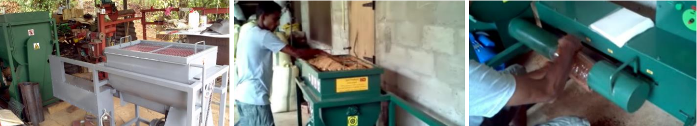
බිම්මල් වගාවේදී ස්වයංක්‍රීයව වගා මාධ්‍යය කලවම් කරන හා මළ පිරවීමේ උපකරණය
